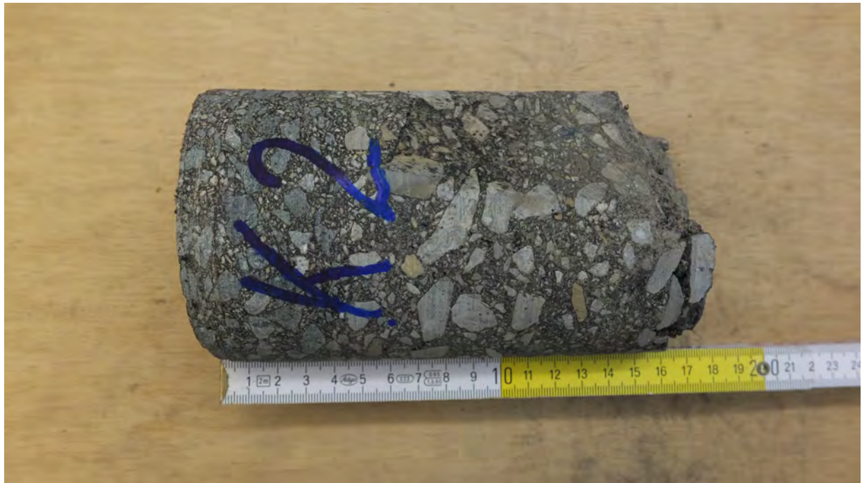
Abb. 2: Asphaltkern "K 2", \varnothing = 10 cm; d = 16 cm (Melkerweg)
