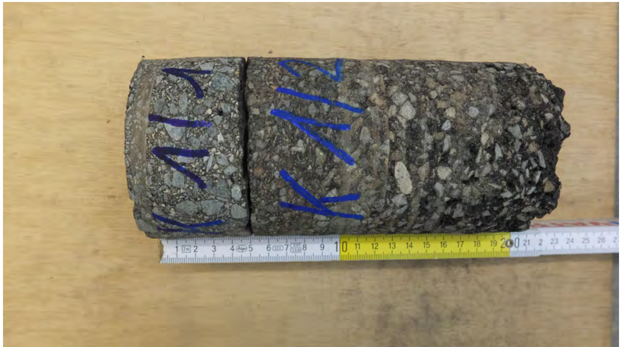
Abb. 1: Asphaltkern "K 1", \varnothing = 10 cm; d = 20 cm (Erlenweg)
