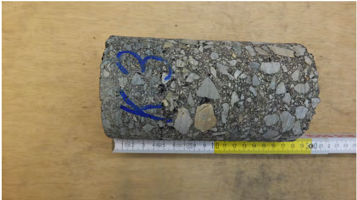
Abb. 3: Asphaltkern "K 3", \varnothing = 10 cm; d = 17 cm (Melkerweg)
